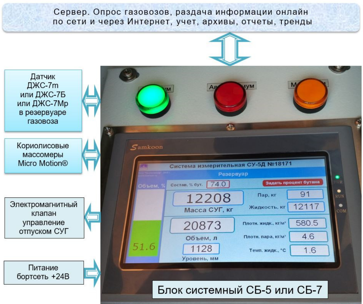
Рис. 2. Измерительная система СУ-5Д-МАСС для газовозов
