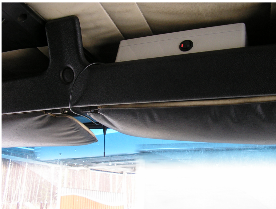
Рис. 5. Блок искрозащиты с GSM модемом
