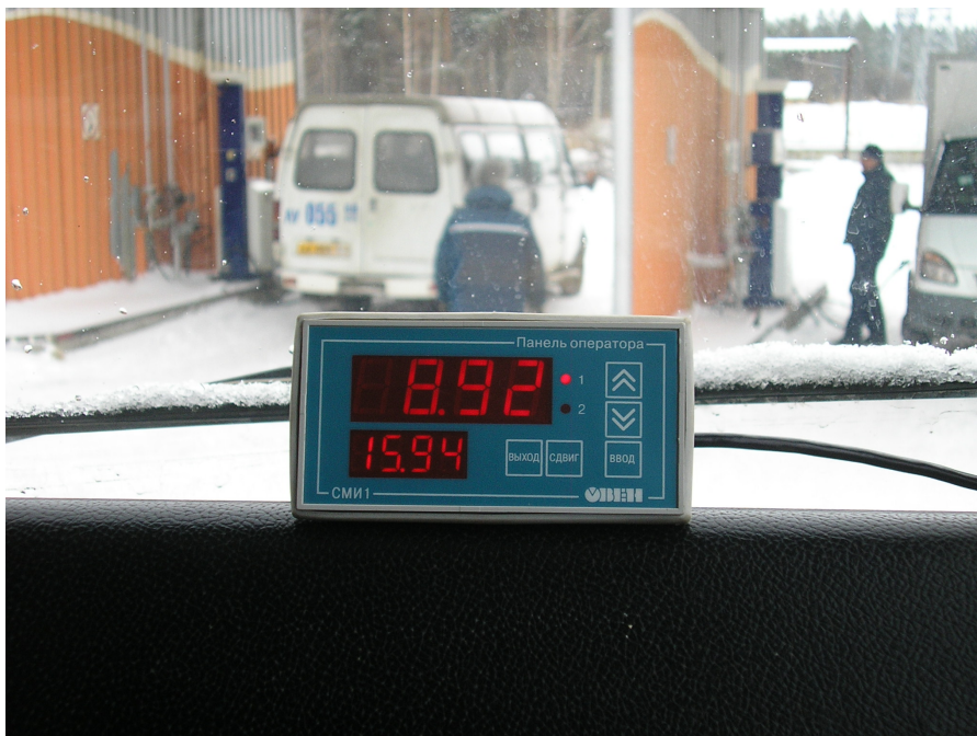
Рис. 6. Индикатор в кабине водителя
