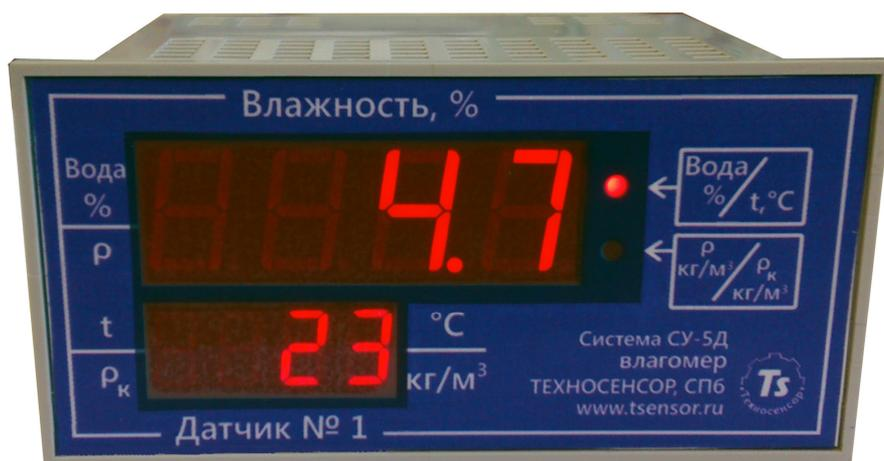
Индикатор выводит два измеряемых параметра в основном режиме и два параметра в дополнительном режиме.
