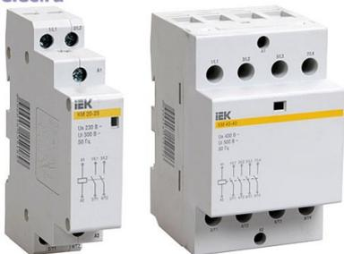
Контактор КМ 40-40 позволяет коммутировать трехфазную нагрузку с током до 40 А. Пусковой ток катушки управления 60 мА. Контакторы крепятся на DIN рейку.
