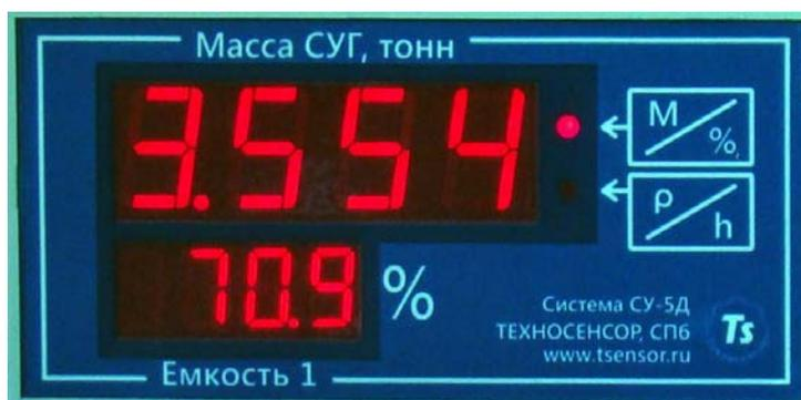
Индикаторы подключаются по двухпроводному интерфейсу RS-485.
