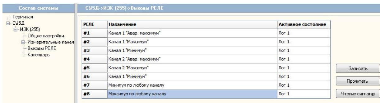
Рис. 16 Настройка выходов РЕЛЕ ИЗК (255)
